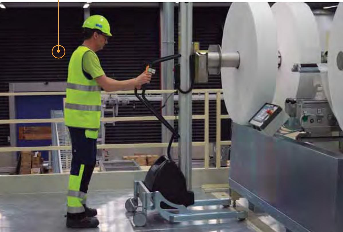
En SCA, en Suecia, se utilizan varias carretillas elevadoras para recoger las bobinas de los palets y transportarlas a las máquinas. Las bobinas se colocan y montan fácilmente en las máquinas. Todo ello con la ayuda ergonómica de los elevadores TAWI.
