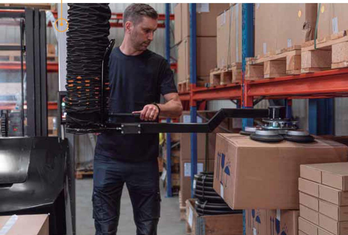
Gracias a la distribución del peso de la herramienta Easy Reach, el operario puede estar cómodamente de pie en el pasillo mientras levanta una caja del extremo posterior de un palet en la estantería.
