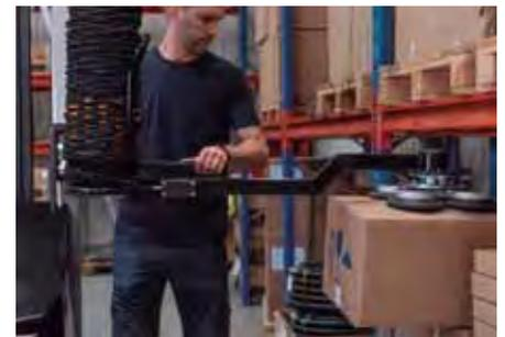
Levante hasta 80 kg sin esfuerzo físico. El elevador evita que el operario levante en posiciones incómodas.
